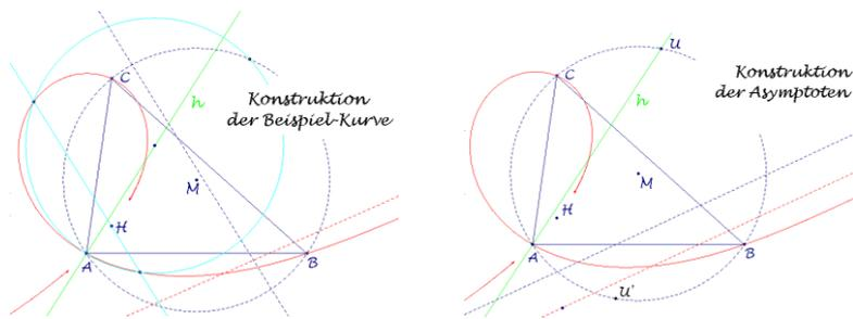
Zur Konstruktion der Asymptoten betrachte man die Simson-Gerade zum diametralen Punkt  $U'$  des zweiten Schnitts  $U$  der erzeugenden Geraden mit dem Umkreis. Spiegelt man  $A$  an dieser Simson-Geraden und zeichnet eine Parallele, so erhält man die Asymptote.
