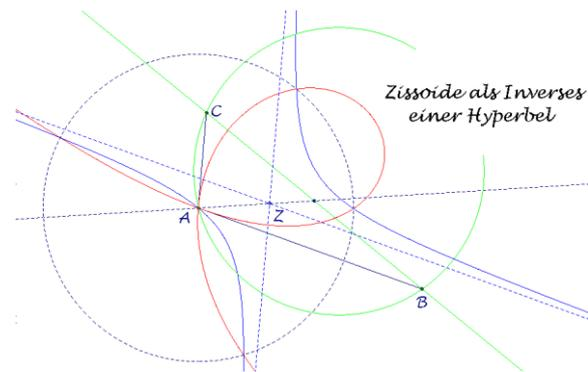
Spiegelt man die  $g$ - $k$ -Zissoide an einem Kreis um  $A$  mit dem Radius  $r$ , so erhält man eine Hyperbel mit der Gleichung
