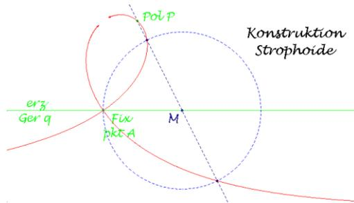
Eine  $g$ - $k$ -Zissoide wird zur Strophoide, wenn die Gerade  $g$  durch die Mitte  $M$  des Kreises  $k$  geht. Diese Kreismitte ist dann der Pol der Strophoide und eine Parallele zur definierenden Geraden durch  $A$  die erzeugende Gerade der Strophoide.
