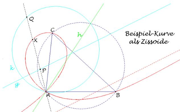
Betrachtet man jetzt eine Gerade durch  $A$ , die die Gerade  $g$  in  $P$ , den Kreis  $k$  in  $Q$  und die Kurve in  $X$  schneidet, dann bestätigt eine Berechnung, die hier unterdrückt sei, dass die Strecken  $PQ$  und  $AX$  gleich lang sind, so dass es sich bei der Kurve um eine  $g$ - $k$ -Zissoide handelt.
